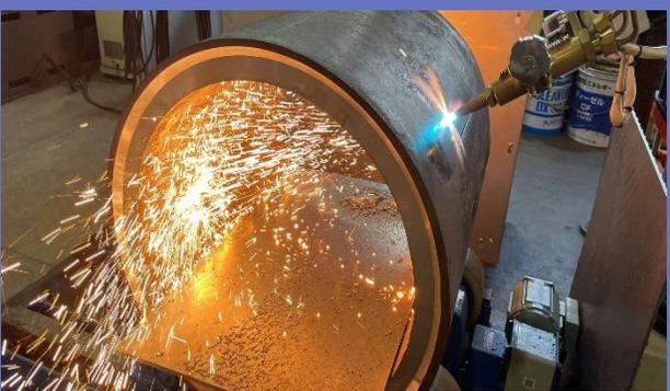
主力商品 鋼板の溶断加工
