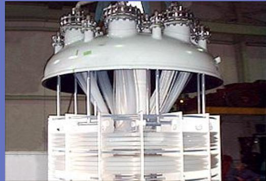
フッ素樹脂製熱交換器（世界最大）
