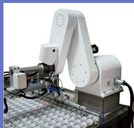
当社製品 Dラック式自動投入機 日本初となる3軸ロボットを使用 0.1mm以下の薄い基板に対応可能
