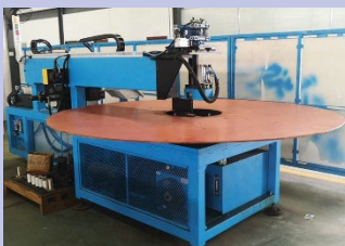
製造設備イメージ（銅管バンダー）
