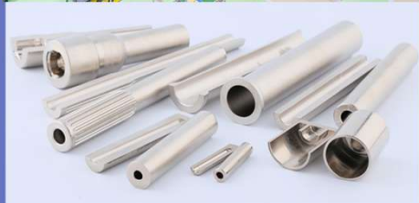
事例紹介：冷間鍛造による中空製品
