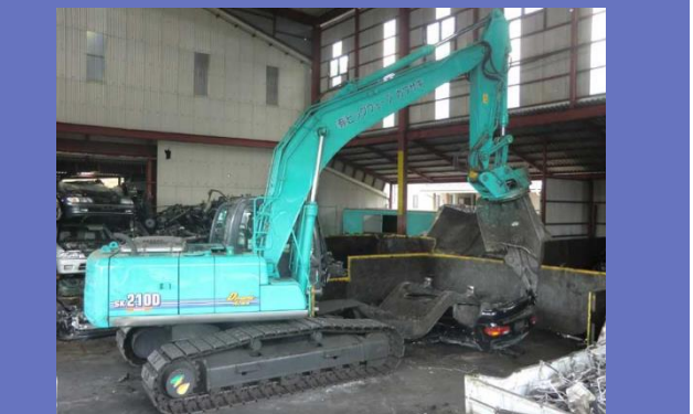
自動車解体機で使用済み自動車からリサイクル素材(鉄・非鉄)を取外しているところ
