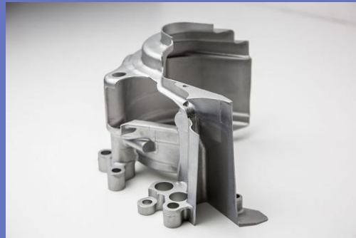
肉厚1.5mmの砂型アルミ铸造品
