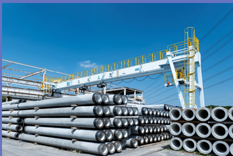
川口工場 製品置き場（PHC杭）
