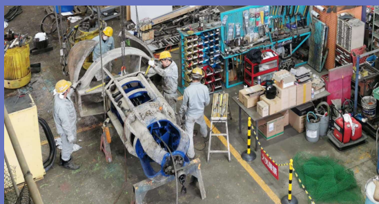
主力製品ハンマージェラブの整備作業
