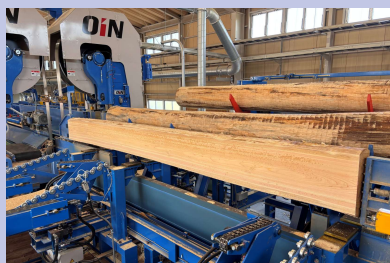
2025年秋に稼働を開始した美濃加茂製材工場では、国産桧の中・大径材を製材
