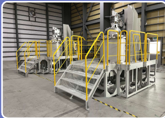
超高温 熱処理装置 (半導体材料の熱加工装置)
